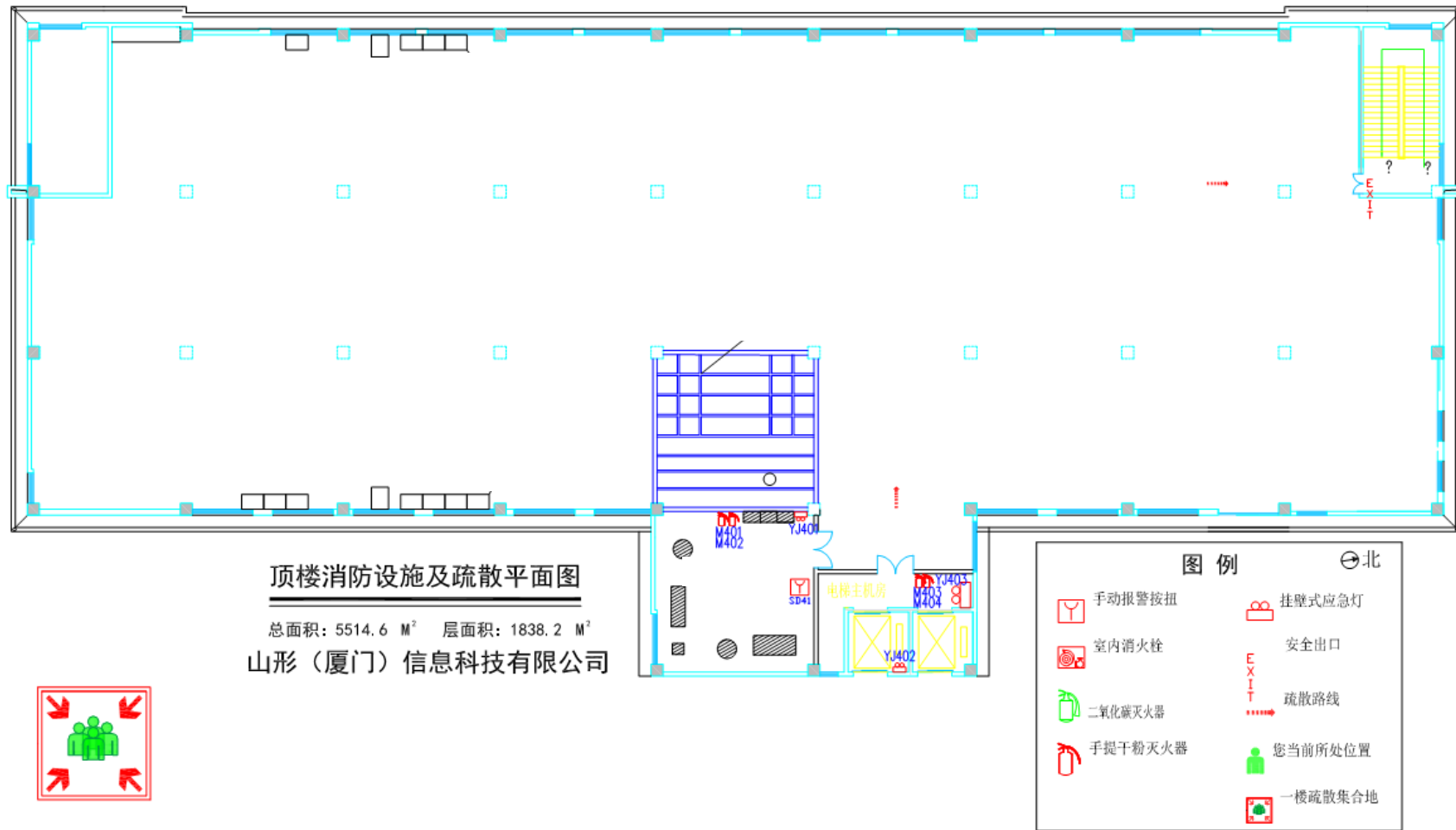
图 10.12.5 厂房内顶楼夹层消防疏散图
